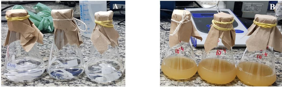
Figura 14. Degradação do papel de filtro (triplicata da diluição 10^{-4} ). (A) antes da incubação. (B) após 120 hs de incubação a 60 °C a 100 rpm. (CRUGEIRA, 2019)
