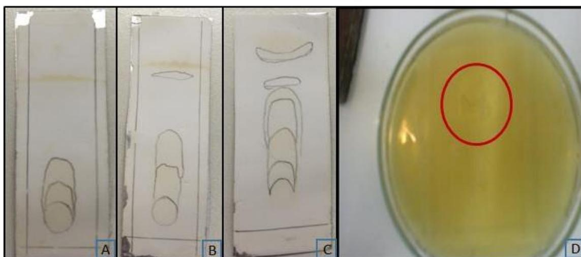
Fonte: Próprio autor. **Onde:** **A** - Representa o solvente com pouca eluição; **B** - Representa a mistura de dois solventes com eluição moderada; **C** - Representa a mistura de dois solventes e água com eluição completa; **D** - Bioautografia com alo de inibição para *C. pseudotuberculosis*.
