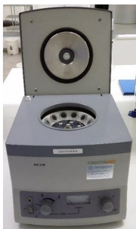
Figura 25. Equipamento centrífuga CENTRIBIO, modelo 80-2B com faixa de rotação de 1000 a 4000rpm
