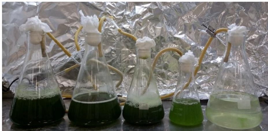
Figura 11. Fotobiorreator com microalgas Dunaliella salina em diferentes fases de crescimento Fonte: Autor (2016)
