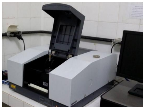
Figura 12. Equipamento de espectroscopia de infravermelho SHIMADZU IRAffinity-1 FT-IR (Fourier Transform Infrared)
