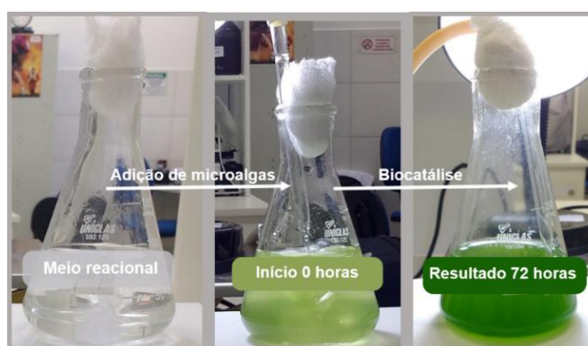
Figura 39. Biotatálise do substrato acetofenona realizada por microalgas Dunaliella salina no período de 72 horas em solução AMA, enriquecida com meio Conway (WALNE 1979)
