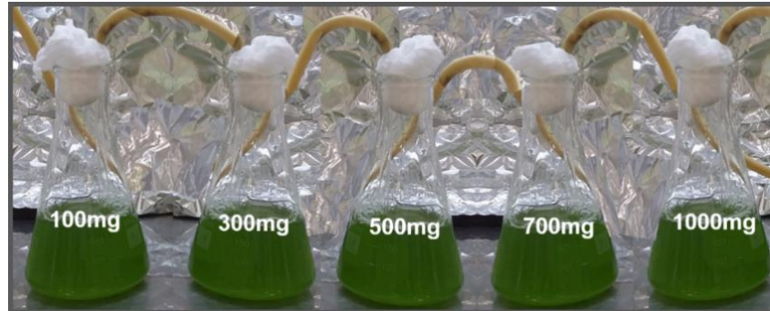
Figura 35. Teste de tolerância do substrato acetofenona com as microalgas Dunaliella salina em meio de cultura saturado, enriquecido com solução principal e de vitaminas, sob aeração e fotoperíodo constante durante 72 horas
