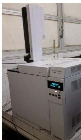
Figura 21. Cromatógrafo gasoso Agilent Technologies 7820A GC System e injetor automático 7693A com capacidade para 16 frascos de amostra
