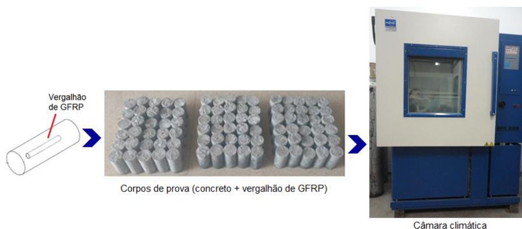
Figura 23. Preparação dos corpos de prova para o envelhecimento acelerado.
