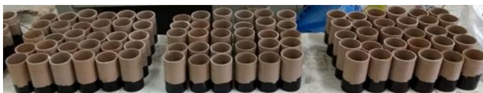
Figura 22. Formas cilíndricas (tubo PVC) utilizados para moldagem do concreto.
