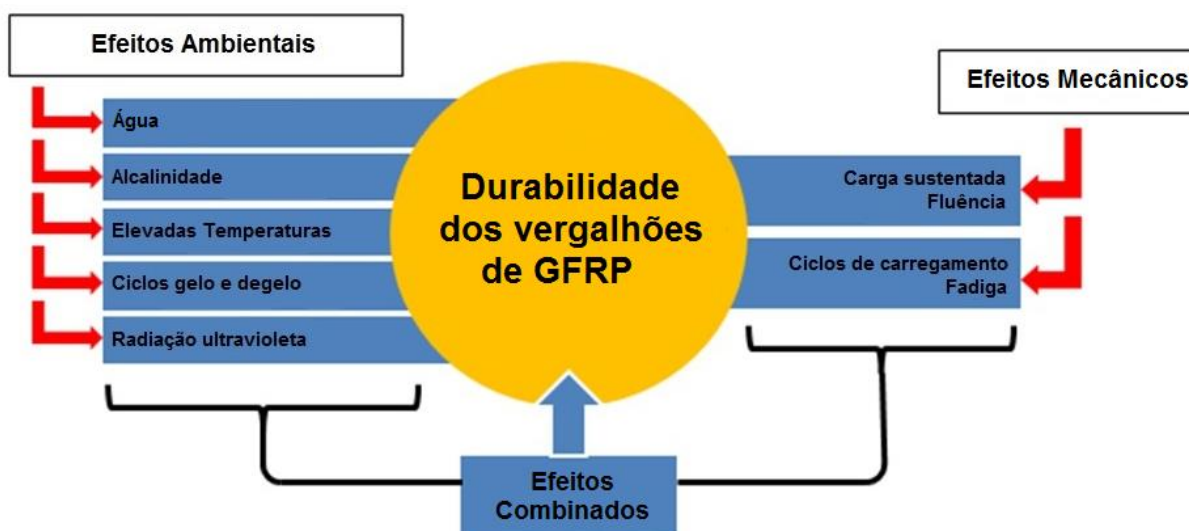
Figura 10. Fatores que podem interferir na durabilidade dos vergalhões de GFRP.
