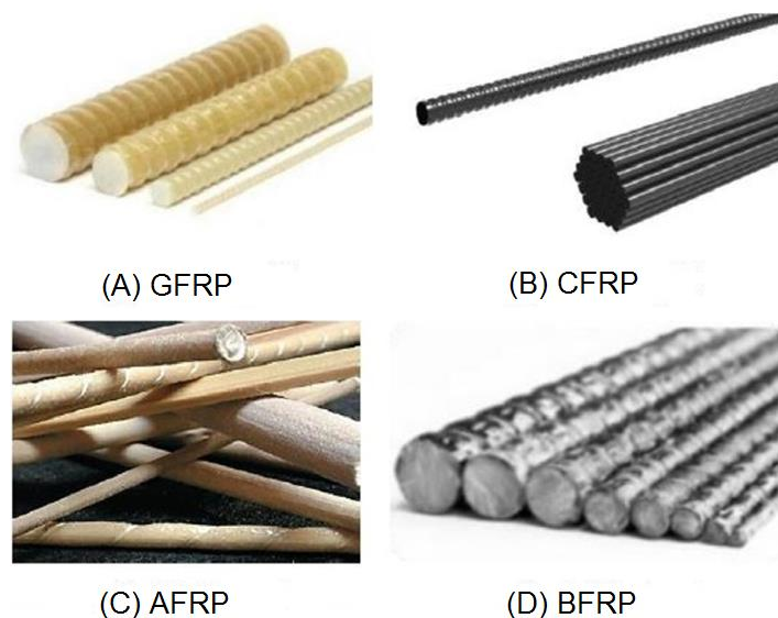
Figura 1. Vergalhões de FRP: (A) com fibra de vidro (GFRP), (B) com fibra de carbono (CFRP); (C) com fibra de aramida (AFRP) e (D) com fibra de basalto (BFRP).
