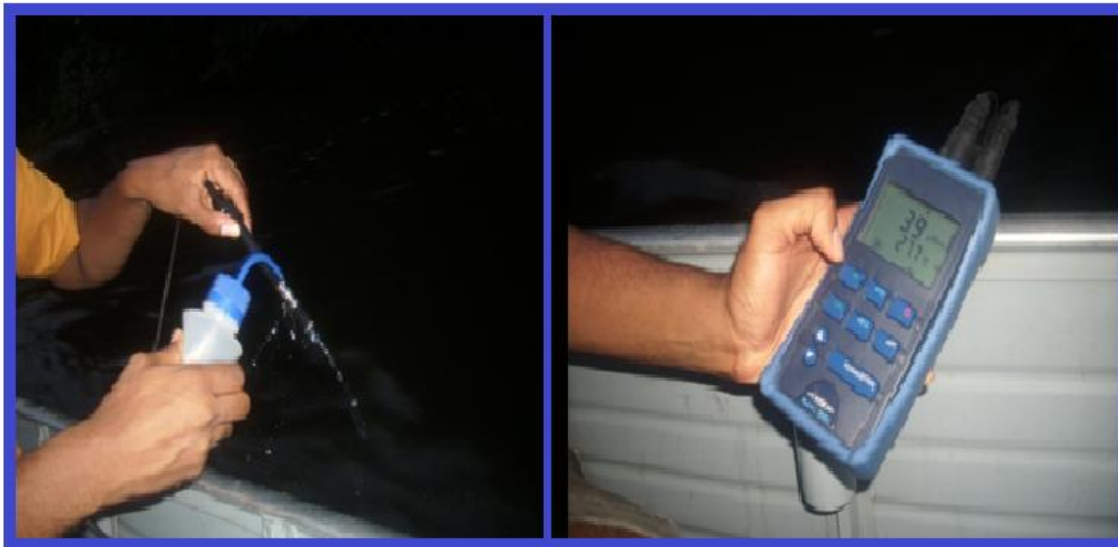
Figura 5 - Medida de parâmetros físico químicos no momento da coleta das amostras.
