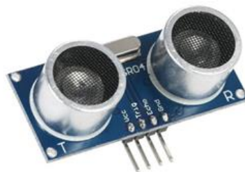
Figura 7 - Conjunto emissor-receptor do sensor ultrassônico
