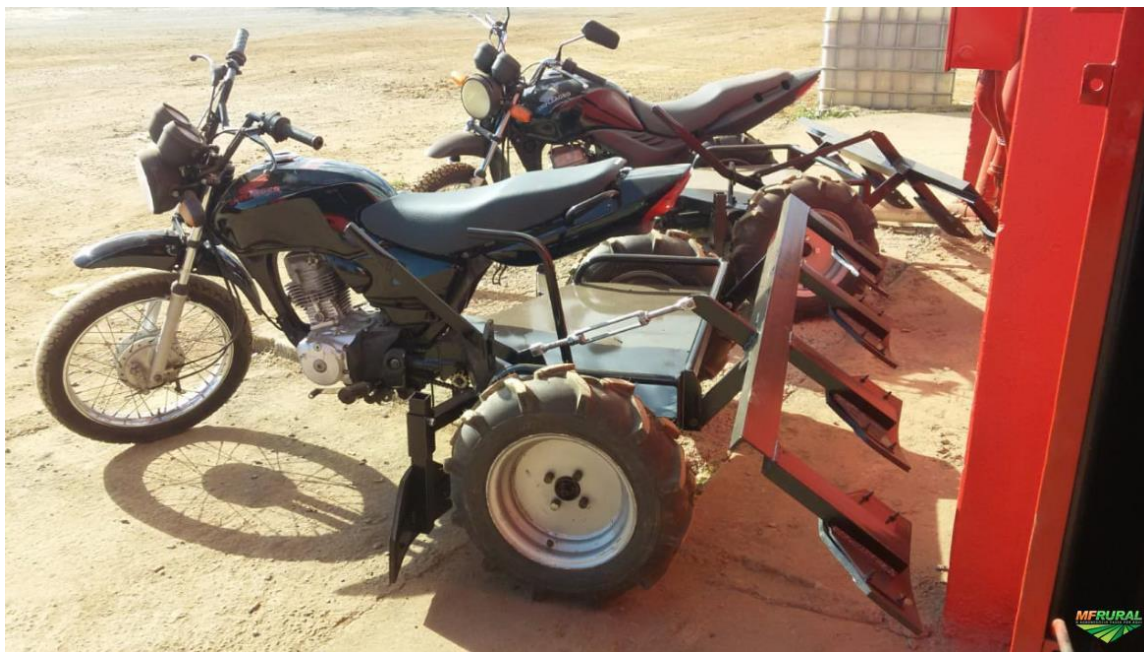
Figura 4: Motocicleta adaptada para espalhar os grãos de café
