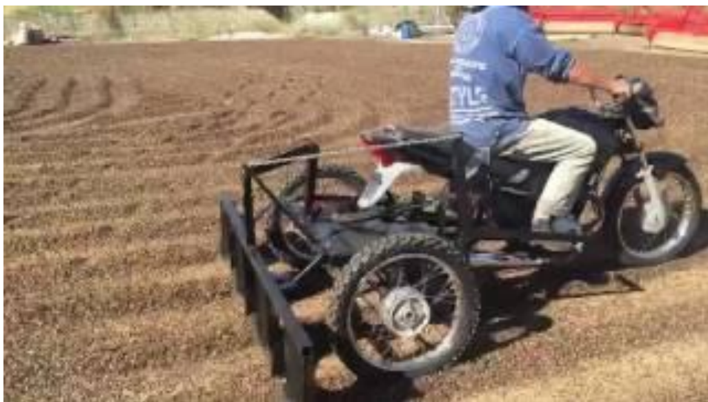
Figura 5 - Motocicleta adaptada para secagem de grãos de café
