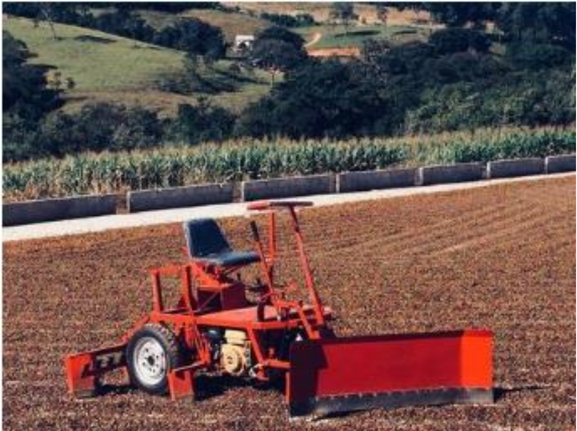
Figura 2 - Máquina para secagem de café em terreiro
