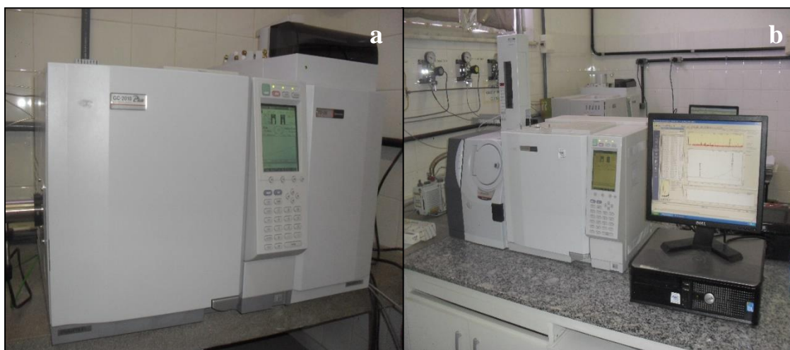
Figura 12. (a) Cromatógrafo a gás acoplado a detector FID e unidade de dessorção térmica. (b) Cromatógrafo a gás acoplado a detector MS.
