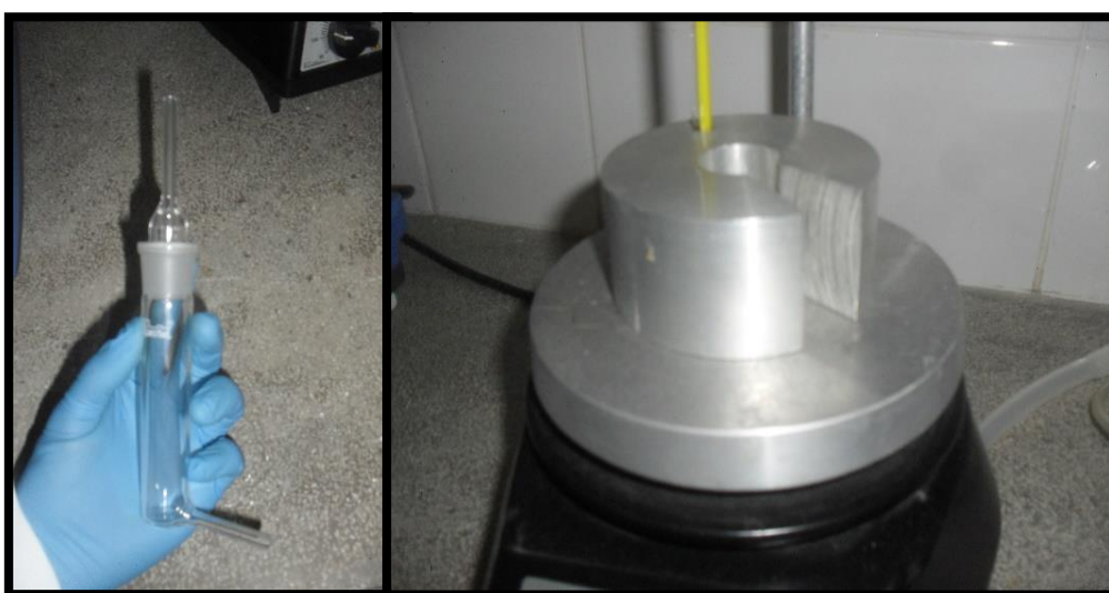
Figura 16. a) Vial modificado e b) bloco de alumínio criados pelo grupo de pesquisa.
