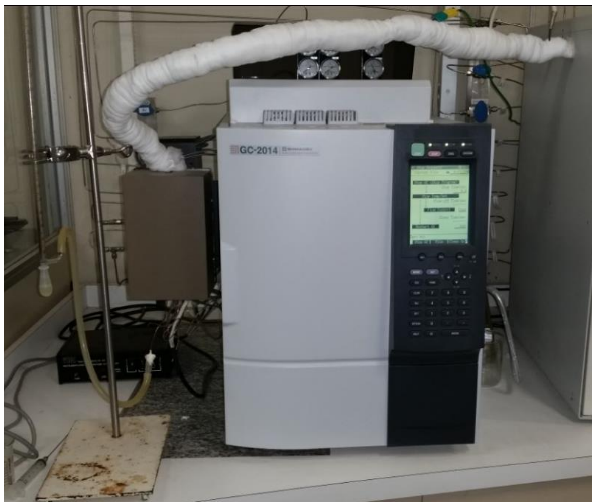
Figura 4.6 - Cromatógrafo a gás utilizado nos testes catalíticos.
