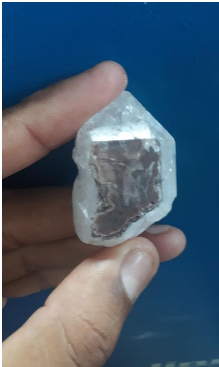
Imagem 52 Incorporações sobre cristais. Revelação fotográfica de incorporação por meio da técnica do Dusting On, óxido de ferro e queima em forno elétrico a 760 °C.
