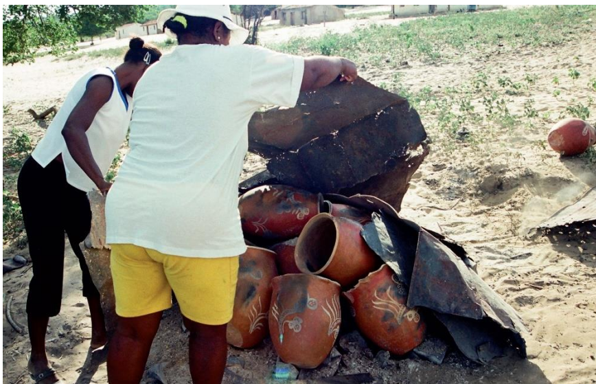
Figura 238 – Artesãs cobrem a cerâmica com chapas de flandres para obter uma distribuição igualitária do fogo na queima das peças. Povoado de Passagem, em Barra (Bahia).
