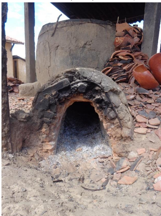
Figuras 240 e 241 – “Forno descoberto” para queima de cerâmica no povoado de Passagem, em Barra (Bahia). Na direita, abertura da parte superior do forno.
