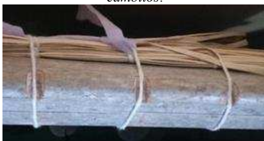
Figura 374 – Encavinhas ou ranhuras no travessão do urdidor onde são fixados os fios dos cambitos .
