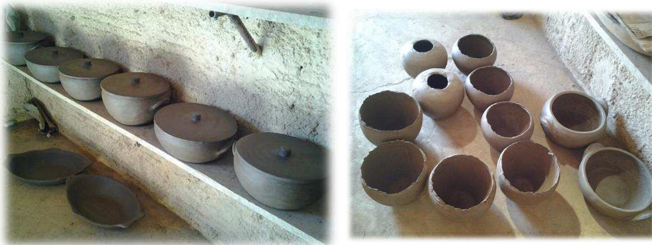
Figuras 188 e 189 – Etapa de secagem das peças de barro na sombra, no povoado de Passagem.
