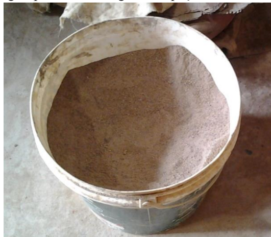
Figura 171 – Pó de cupinzeiro queimado utilizado pelas artesãs de Passagem na mistura de argila para a modelagem das peças de cerâmica.
