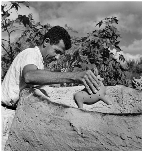
Figura 229 – Mestre Vitalino e o seu “forno descoberto” para queima de cerâmica.
