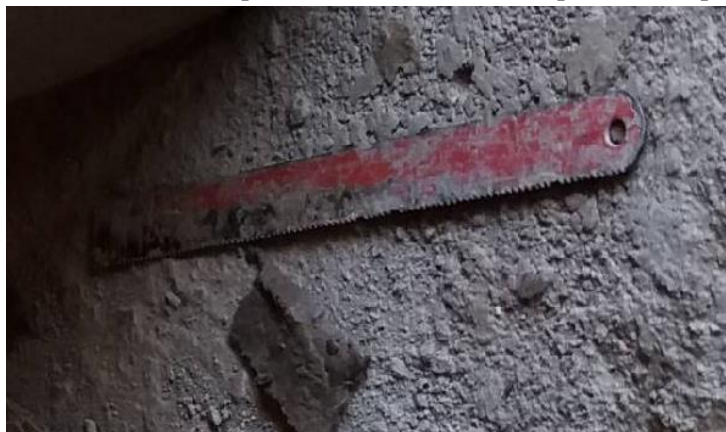
Figura 95 – Serra utilizada pelas artesãs da Associação de Cerâmica Comunitária Nossa Senhora de Fátima para realizar incisões na superfície das peças.
