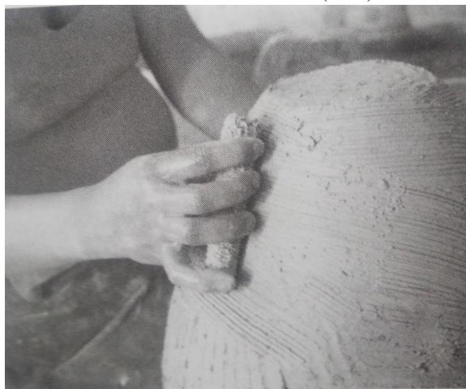
Figura 186 – Alisamento de um pote de cerâmica com sabugo de milho, realizado pela artesã Adilma Pereira dos Santos (Dina).
