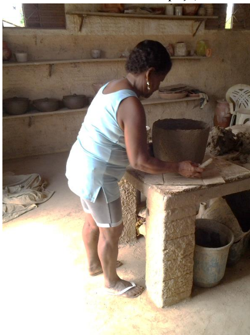
Figuras 184 e 185 – Artesã Deltrude Xavier dos Santos (Dé) realizando a etapa de brunimento de uma peça, com o auxílio de um sabugo de milho.
