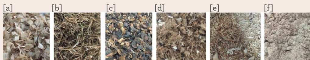
Figura 2. Tipos de fibras naturais adotadas na: [a] palha de milho (PM); [b] palha de feijão (PF); [c] casca de café (CC); [d] bagaço de cana de açúcar + capim braquiária + serragem de madeira dura (BC+CB+SMD); [e] serragem de madeira dura do FabLab (SMD); [f] pó de MDF do FabLab (MDF)
