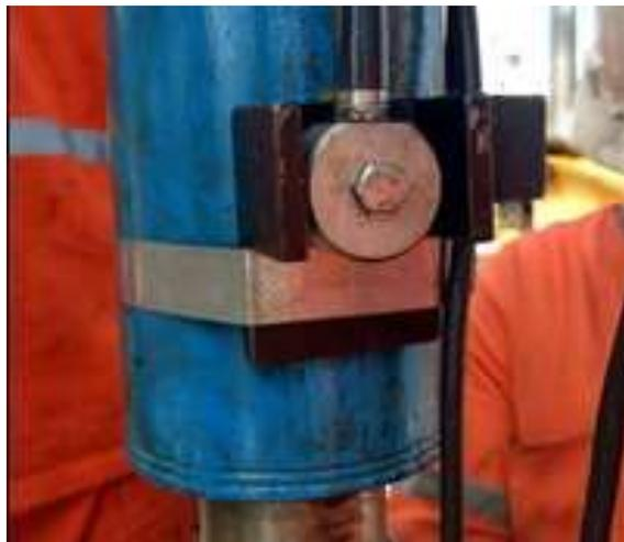
Figura 6.37. Exemplo de fixação de acelerômetros em bomba de BCS, em ambos os experimentos de coleta de dados, usando fita de aço. Fonte: do autor.
