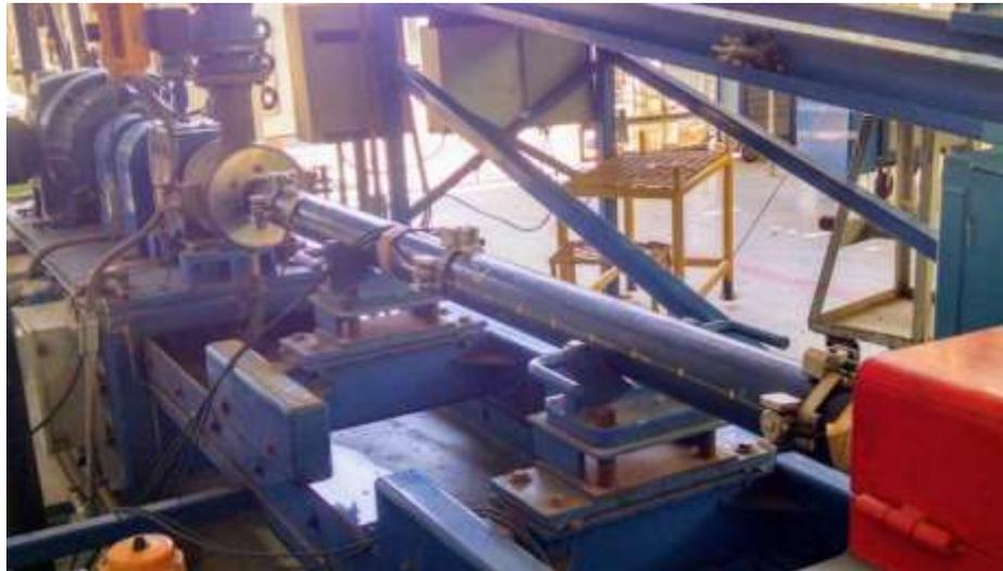
Figura 6.35. Bancada horizontal de avaliação de bombas de BCS na UE-BCS (Unidade Especializada em Sistemas Bombeio Centrífugo Submerso) da Petrobras na cidade de Mossoró-RN. Fonte: do autor.
