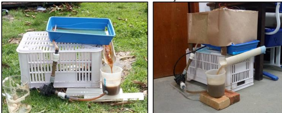
Figura 5 – Sistema de tratamento Fenton em duas situações distintas
