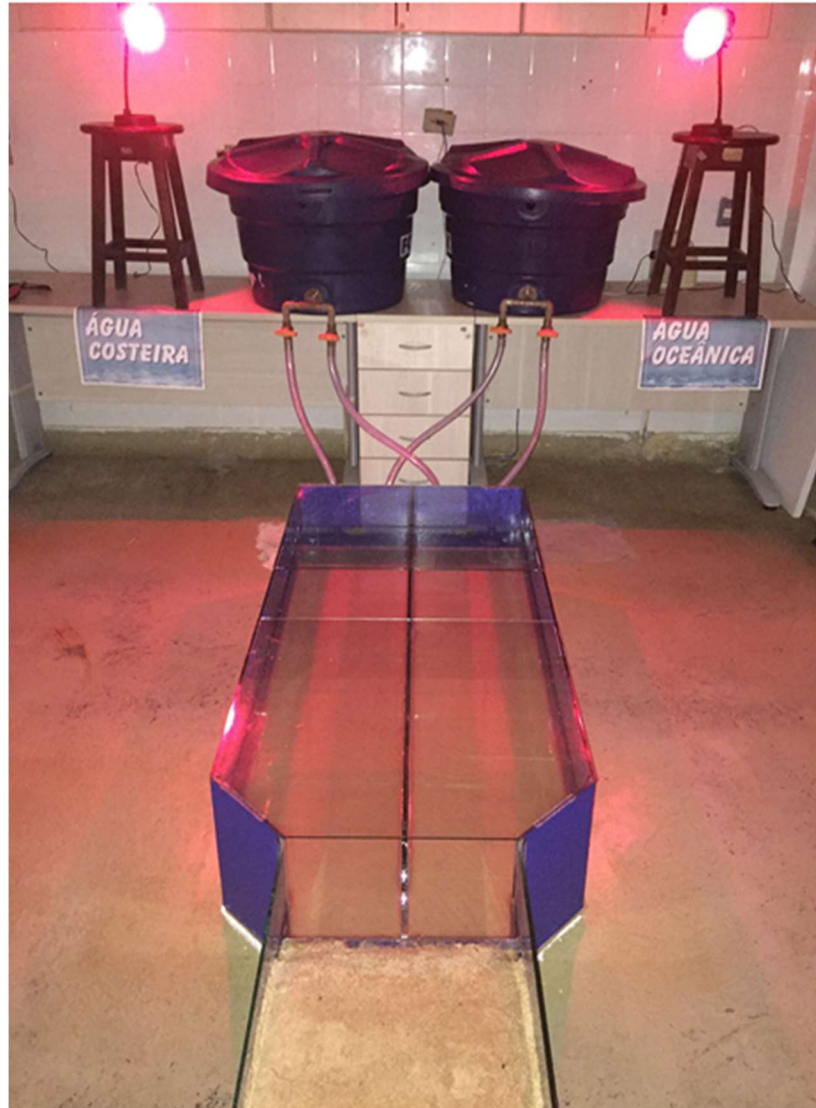
Figura 3: Tanque Y com fluxo de água de origens distintas (costeira e oceânica) são representadas em cada lado do tanque. Luminárias com lâmpadas vermelhas em Led de 5 W, posicionadas ao lado dos reservatórios, para permitir visibilidade do procedimento experimental minimizando qualquer interferência luminosa nas tartarugas.
