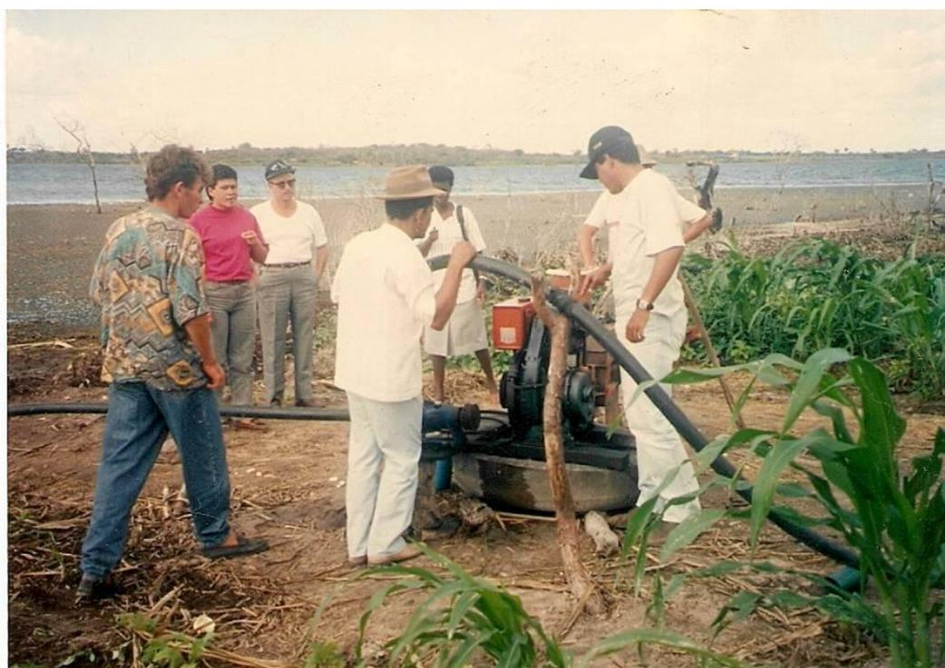
**Figura 4.** Motor-bomba para irrigação da primeira roça.
