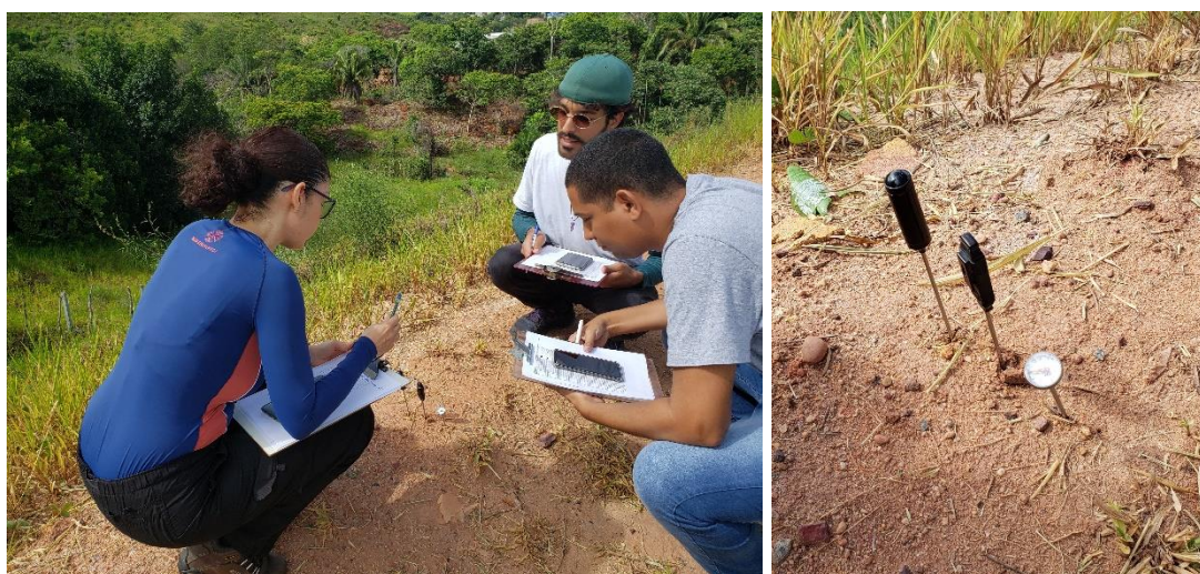
Figura 56 – Verificação dos termômetros digitais industriais com a equipe de campo no município de Salvador
