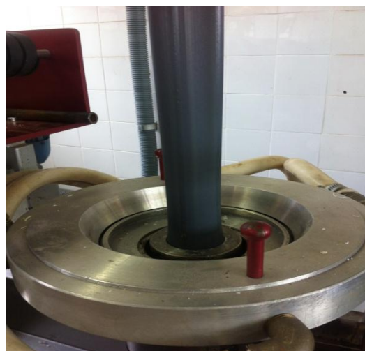
Figura 5 - Extrusão por sopro dos filmes de amido e gelatina.
