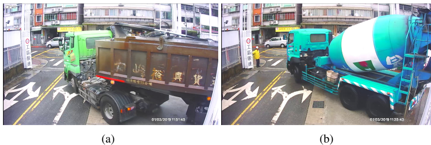
Figura 2.6: Exemplo de aplicação de classificação de imagens: máquinas na construção. (a) Caminhão do tipo dump truck . (b) Caminhão do tipo concrete mixer truck . Fonte das fotografias: ACID dataset [40].
