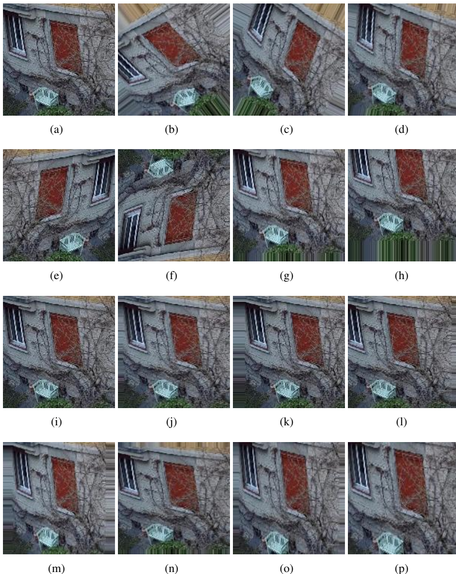
Figura 4.1: Exemplos de imagens geradas com data augmentation (biblioteca Keras): (a) imagem original; (b) - (d) rotação ( R = 40 ); (e) flip horizontal ( H = TRUE ); (f) flip vertical ( V = TRUE ); (g) e (h) deslocamento em altura ( He = 0.2 ); (i) cisalhamento ( S = 0.2 ); (j) - (l) deslocamento em largura ( W = 0.2 ); (m) - (p) zoom ( Z = 0.2 ).
