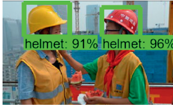
Figura 3.2: Exemplo de detecção de equipamentos de proteção usando deep learning (Fonte: [133]).
