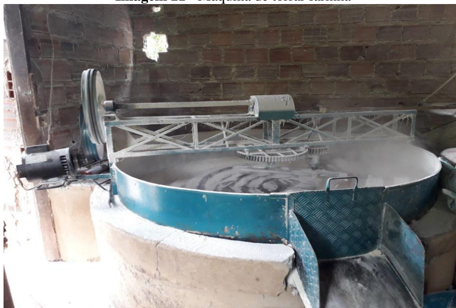
Máquina elétrica de torrar farinha de mandioca. Foto: Autora, 2022
