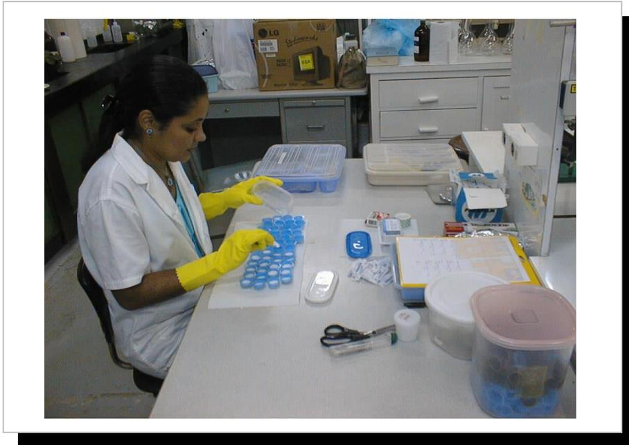
**Figura 23.** Foto da montagem dos amostradores passivos
