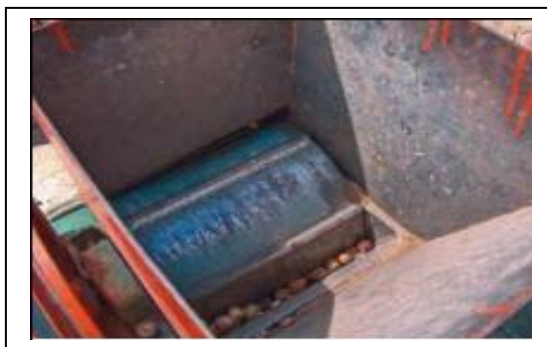
Figuras 18 e 19: máquina para quebrar coquinhos de licuri
