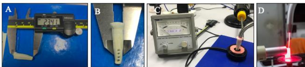
FIGURA 3: (A) Comprimento da raiz inicial, (B) Marcações na raiz a cada 1mm, (C) Power Meter e a raiz fixada no suporte, (D) laser com a fibra acionado no interior do canal radicular. (PPGBIOTEC/2022)
