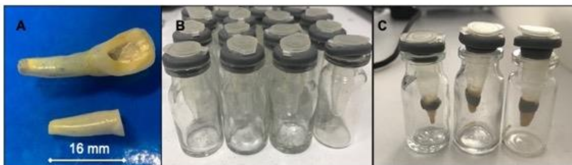
FIGURA 1 : (A) Cavidade de acesso coronal e padronização do comprimento radicular em 16 mm; (B) Dispositivo (tubo tipo penicilina acoplado ao Eppendorf); (C) dispositivo completo com a raiz. (PPGBIOTEC/2022)
