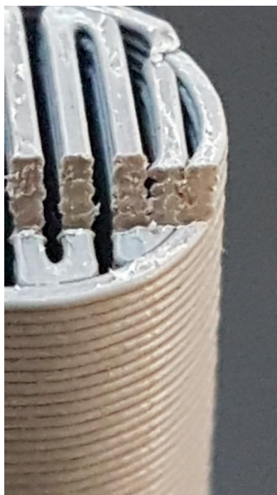
Figura 3.26: Foto de um corte transversal da região de gauge de um espécime, mostrando o acamamento linear do preenchimento com o mesmo ângulo em todas as camadas.
