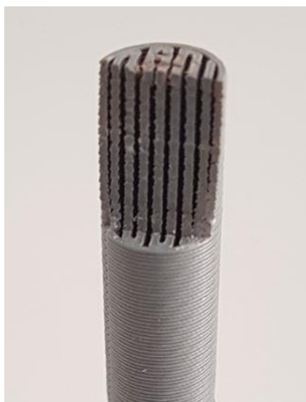
Figura 4.14: Detalhe de um corte num espécime para a medida da Linha Plana.
