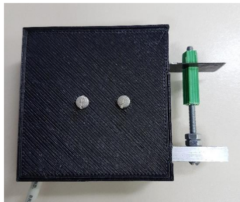
Figura 3.19: Extensômetro mais sensível para os testes com as amostras desta pesquisa.
