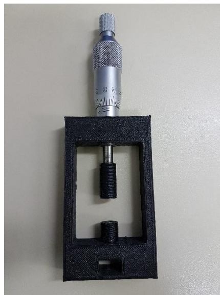
Figura 3.20: Calibrador para o extensômetro mais sensível.
