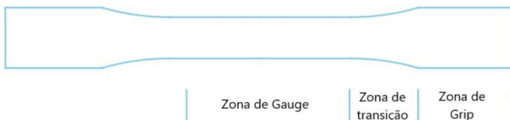
Figura 2.1: Geometria da amostra para teste de tração – ASTM D638
