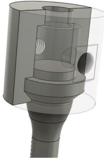
Figura 4.3: Geometria do espécime cilíndrico projetado com "split-collar" (topo do espécime).
