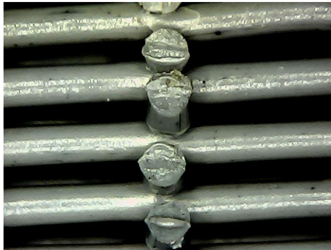
Figura 3.25: Foto ampliada mostrando como se dá o acamamento no preenchimento cruzado
