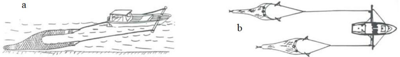
Figura 13. Desenho esquemático das redes-de-arrasto utilizadas na pesca de camarão no Nordeste Brasileiro. a) rede-de-arrasto simples (uma rede) e b) rede-de-arrasto duplo (duas redes).
