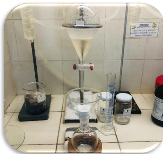
Figura 11 – Extração líquido-líquido de amostras com petróleo. (a) Separação da fase orgânica por decantação. (b) Filtragem do analito e transferência para balão de fundo redondo
