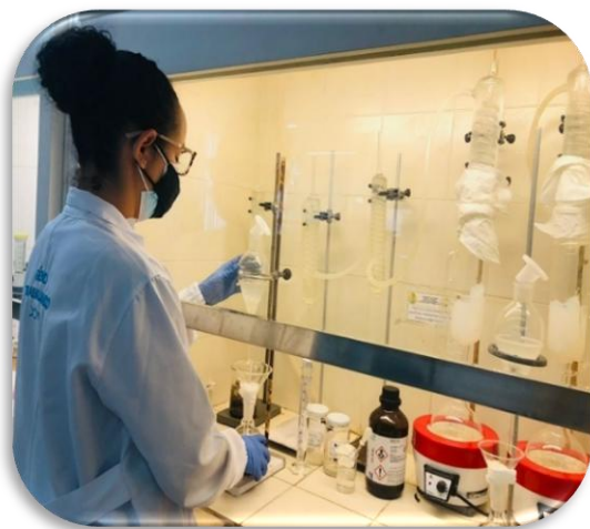
Figura 11 – Extração líquido-líquido de amostras com petróleo. (a) Separação da fase orgânica por decantação. (b) Filtragem do analito e transferência para balão de fundo redondo
