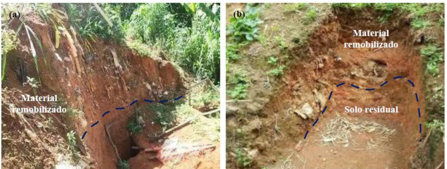
**Fig. 7.15:** Feição erosiva provocada pelo escoamento superficial concentrado e consequente solapamento de margens e abatimento do substrato. 25-Sabiá (558126mE/8579332mN).
