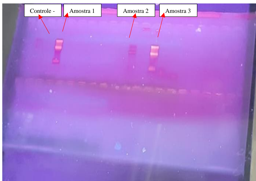
Figura 09. Corrida de eletroforese com controle negativo da corrida e amostras Fonte. Próprio autor, 2023.
