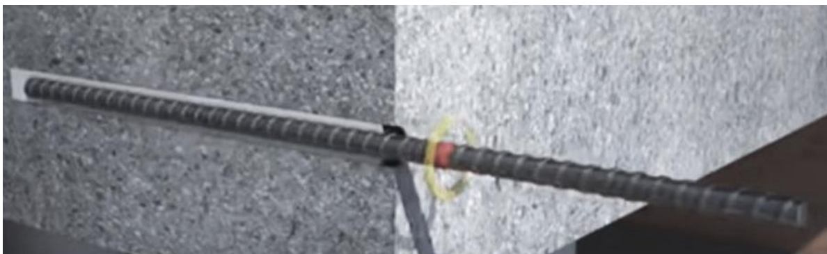
Figura 149 - Esquema de fixação de parafuso com adesivo epóxi, isolando-o da alvenaria
