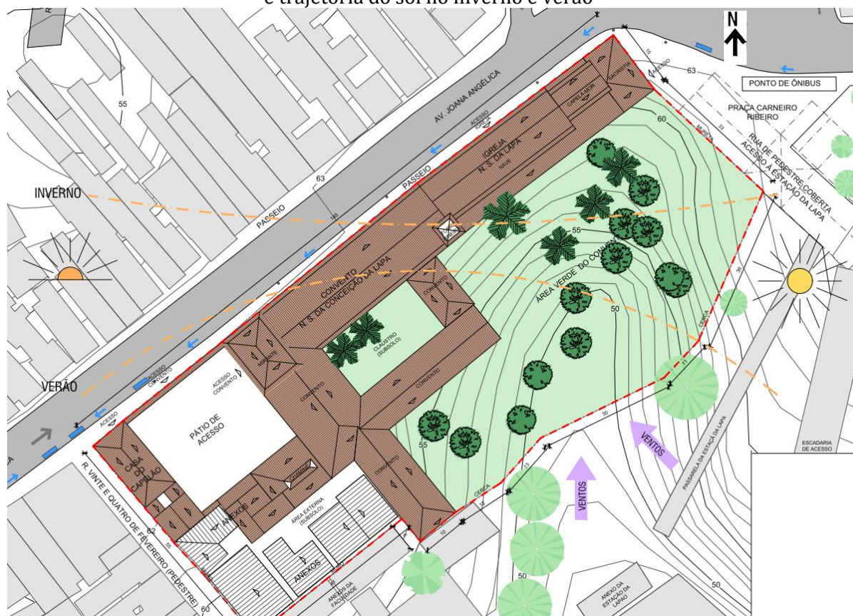
Figura 109- Planta de situação com indicação dos ventos predominantes em período chuvoso e trajetória do sol no inverno e verão
