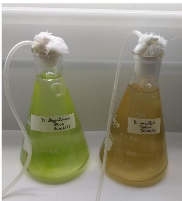
O pH dos meios foi ajustado para  $7,1 \pm 0,1$ , e autoclavado por 20 minutos a  $121^\circ\text{C}$ .
