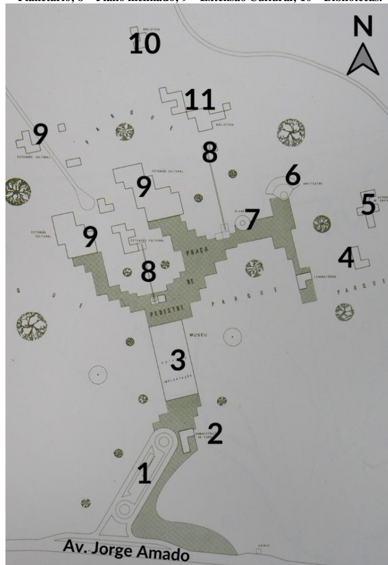
Figura 10 - Trecho ampliado da planta de situação com a organização espacial do MCT-BA. 1- Estacionamento; 2 – Administração do Parque; 3- Edifício de Exposições; 4 – Laboratórios; 5 – Extensão de ensino; 6 – Anfiteatro; 7- Planetário; 8 – Plano inclinado; 9 – Extensão Cultural; 10 – Bibliotecas.
