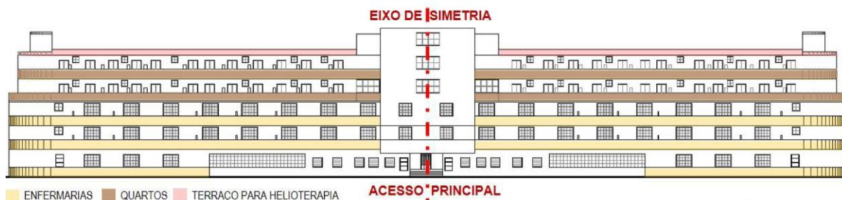
Figura 202 – Fachada principal do Hospital Santa Terezinha, de orientação nordeste, com marcação do acesso principal, que coincide com o eixo de simetria do edifício: a horizontalidade das varandas e as esquadrias no plano recuado traduzem os tipos de uso estabelecidos para cada pavimento.
