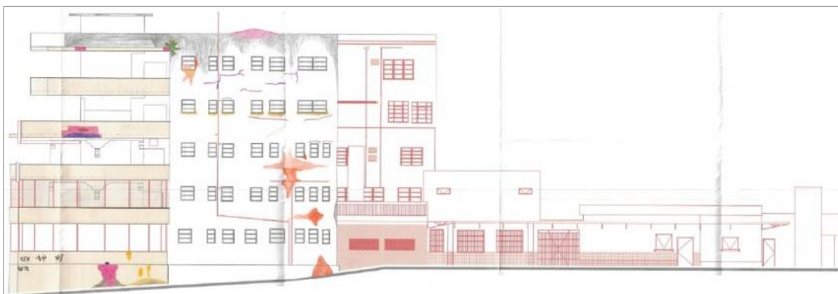
Figura 359 – Mapeamento de danos na fachada noroeste do HEOM.
