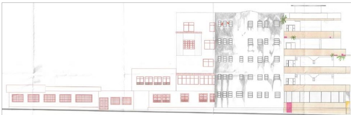
Figura 357 – Mapeamento de danos na fachada sudeste do HEOM.
