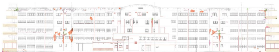
Figura 360 – Mapeamento de danos na fachada sudoeste do HEOM.
