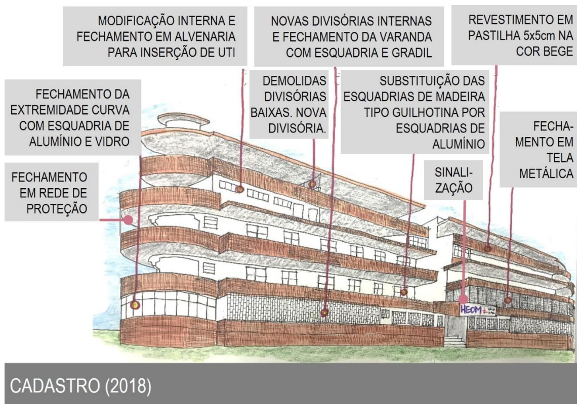
Figura 352 – Fachada nordeste do HEOM e suas alterações observadas no cadastro de 2018.
