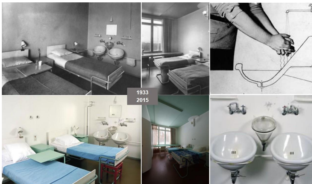
Figura 105 – Quarto de internação preservado no museu do Paimio, com seus móveis originais e os detalhes da pia antirrespingo projetada para o sanatório, denotando os seus princípios higiênicos.
