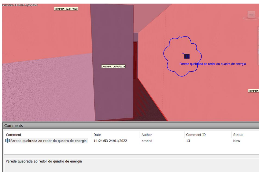
Figura 36 – Modelo 4D com atividades atrasadas em vermelho e problema de terminalidade destacado através do uso de tag, nuvem de revisão e comentário
