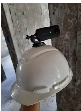
Figura 28 – Câmera 360 e acessório para capacete
