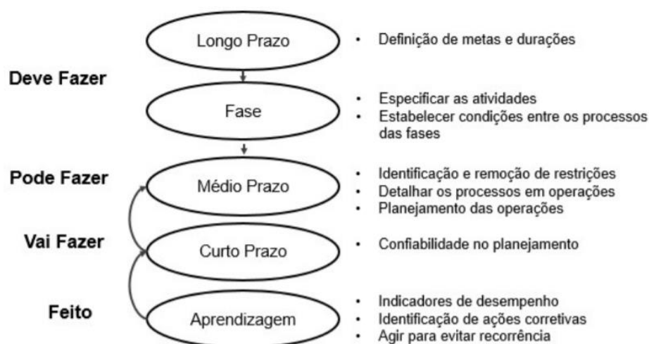
Figura 8 – Níveis hierárquicos do planejamento de acordo com o Sistema Last Planner
