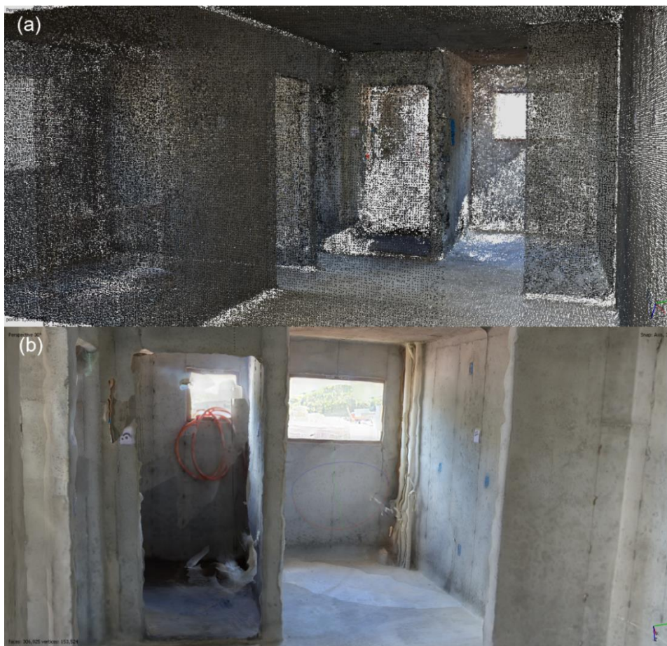
Figura 40 – Visualização no ambiente do Metashape de (a) nuvem de pontos interna da Obra A, e (b) modelo 3D texturizado do mesmo local
