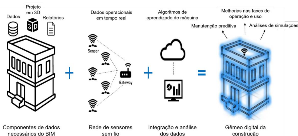
Figura 6 – Componentes para criação de um gêmeo digital através de BIM
