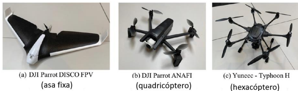
Figura 14 – Alguns tipos de RPA: (a) de asa fixa; (b) e (c) de asas rotativas
