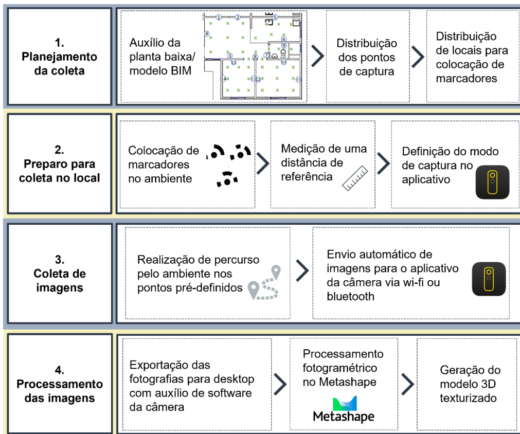
Figura 31 – Procedimento adotado para coleta de imagens com câmera 360° e processamento fotogramétrico
