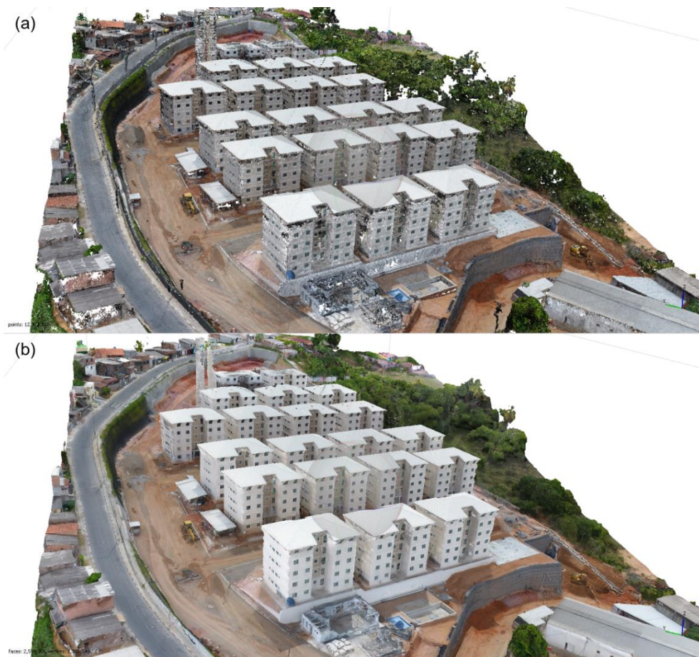
Figura 41 – Visualização no ambiente do Metashape de (a) nuvem de pontos externa da Obra A, e (b) modelo 3D texturizado do mesmo local
