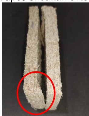
Figura 59: Corpo-de-prova após encurtamento no ensaio de compressão.
