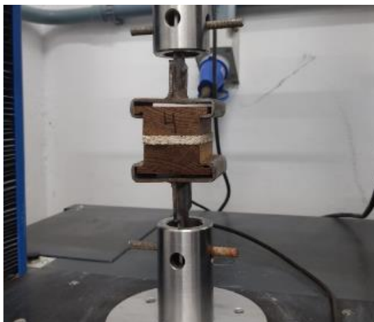
Figura 45: Execução do ensaio de tração perpendicular.
