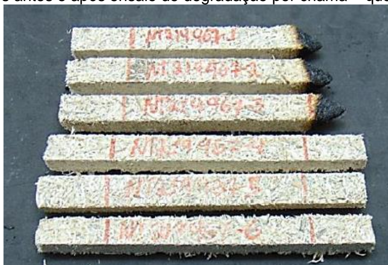
Figura 61: CPs antes e após ensaio de degradação por chama – queima horizontal.
