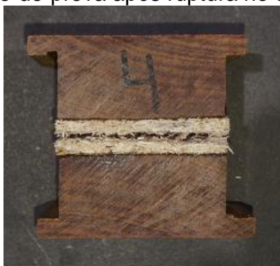
Figura 58: Corpo-de-prova após ruptura no ensaio de tração.
