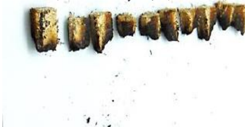
Figura 62: CPs após ensaio de degradação por chama – queima vertical.
