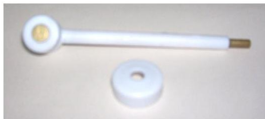
Figura 4.2 – Fotografia do suporte cilíndrico utilizado nas medidas eletroquímicas para acomodação do eletrodo de trabalho (substrato de carbono).
