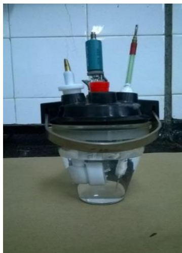
Figura 4.3 – Fotografia da célula eletroquímica e dos eletrodos utilizados nas medidas eletroquímicas.
