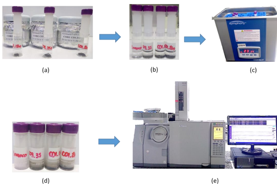
Figura 2 – Etapas do procedimento de microextração assistida por ultrassom empregada para as amostras de sedimento e análise.
