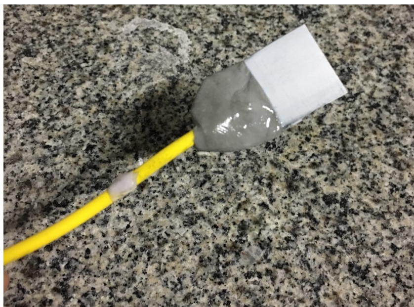
Figura 16: Depósito bem aderido, revestimento feito com NC de algodão.
