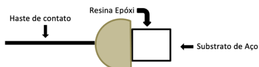
Figura 13: Modelo do substrato de aço carbono AISI 1020.
