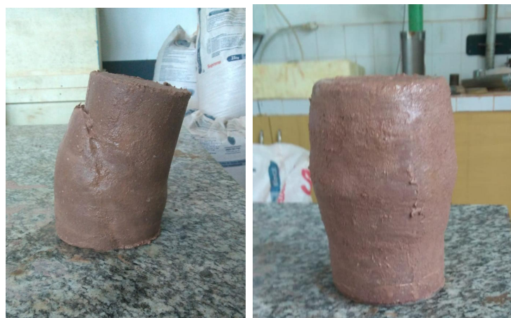
Figura 4.7 – Forma de ruptura do solo estudado: (a) Amostras com 50 e 100 kPa de tensão confinante; (b) Amostras com 200 kPa de tensão confinante.
