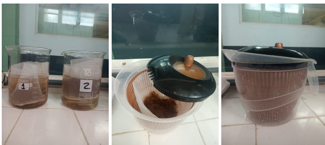
Figura 3.6 – Ensaio de capacidade de absorção de água (a) Fibras submersas. (b) Fibras submetidas à centrifuga. (c) Centrifuga manual utilizada.
