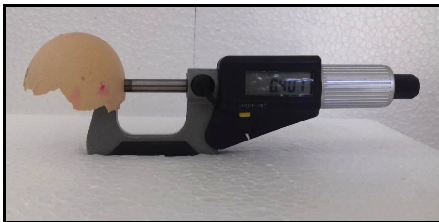
Figura 3 – Medição da espessura da casca dos ovos. Fonte: Arquivo pessoal.
