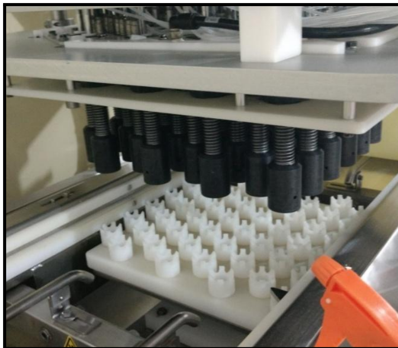
Figura 4 – Testes de injeção da vacinadora in ovo . Fonte: Arquivo pessoal.
