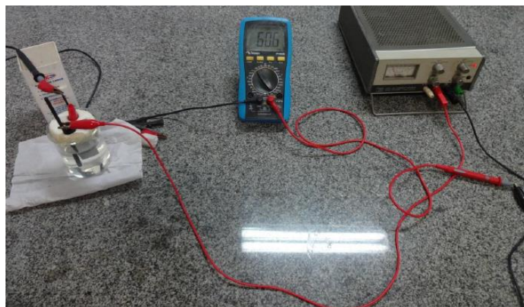
Figura 11 – Imagem do circuito para eletrodeposição utilizado na obtenção de depósito de zinco.
