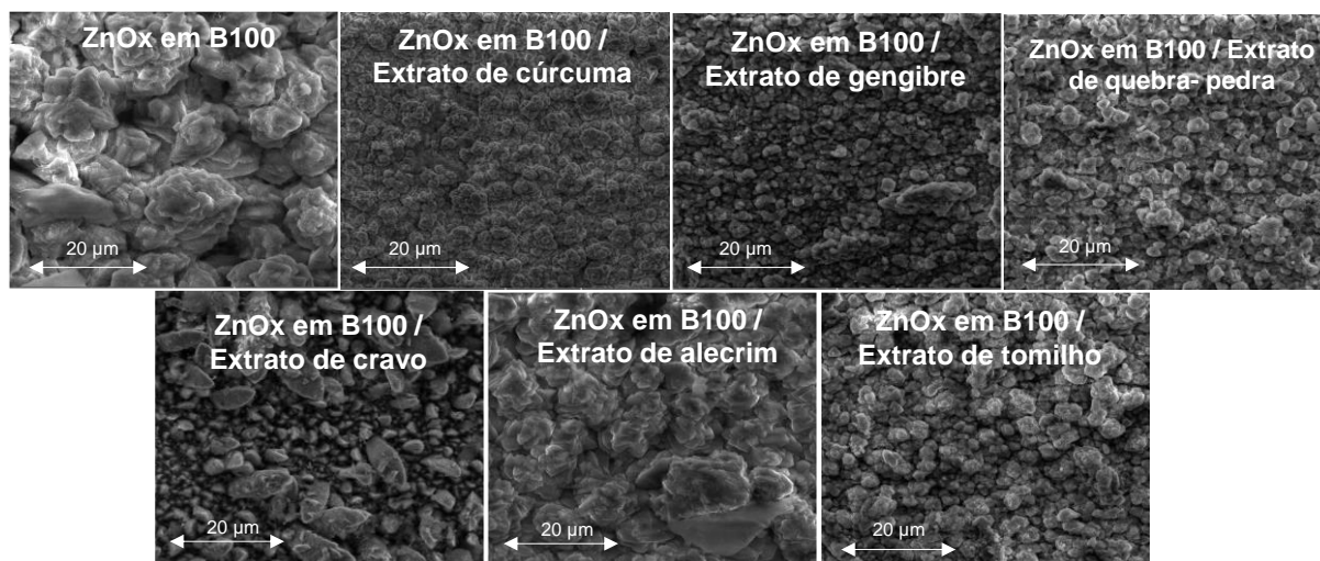
Figura 25 – Micrografias SEM do revestimentos de zinco em solução oxálica (ZnOx) imersos em B100 na ausência e presença de diferentes aditivos.
