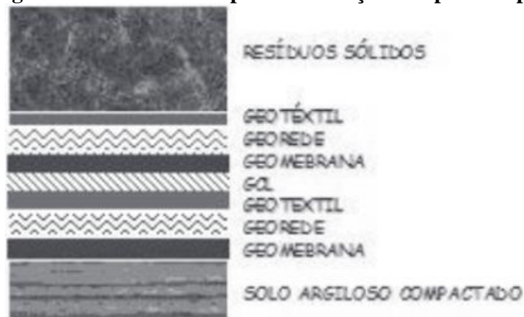
Figura 10. Sistema de impermeabilização composto duplo
