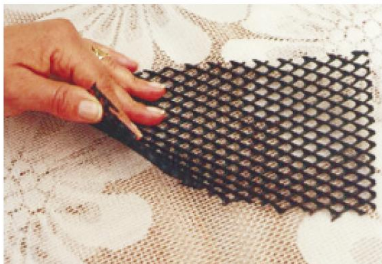
Figura 8. Georrede de PEAD
