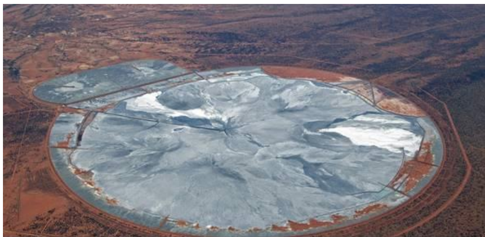
Figura 4- Método de disposição utilizando a técnica do empilhamento drenado.
