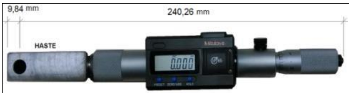
Figura 15 – Micrômetro com suas dimensões.
