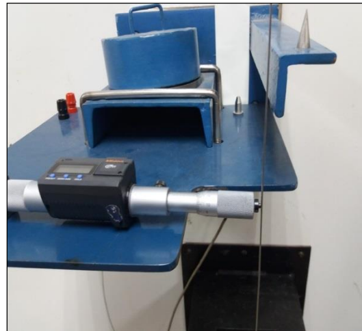
Figura 25 – Toque do micrômetro no fio.
