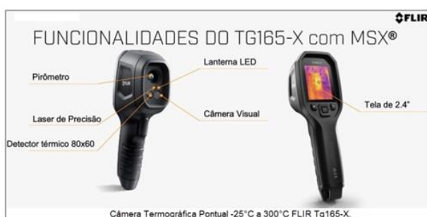
Figura 20: Medidor Termográfico dos Módulos FV. Fonte: Internet (2022).
