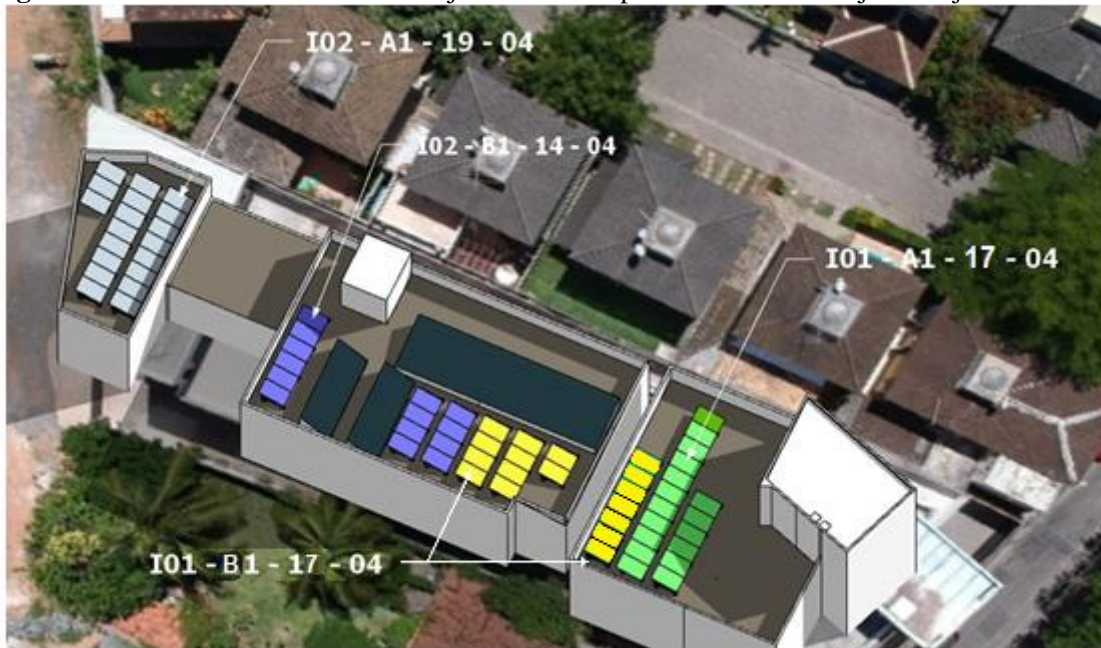
Figura 25 - Sombreamentos nos Arranjos FV do Lar para Idosos FLH de junho a julho de 2020.
