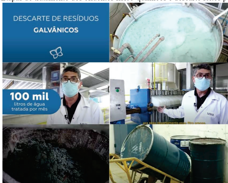
Figura 139 – Etapas de tratamento dos efluentes físico-químicos e descarte feitos pela Rommanel.
