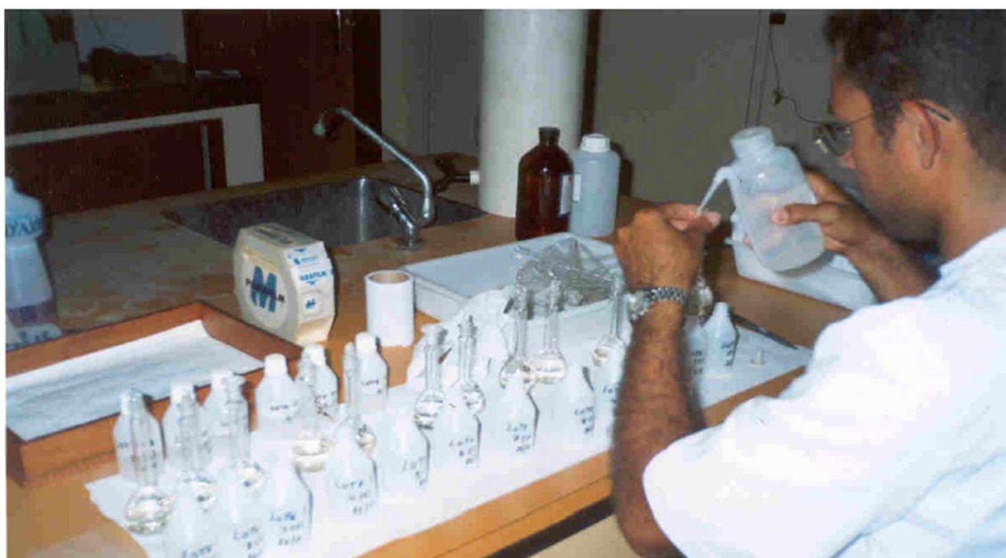
Foto 4.5 – Balão de 50 mL com as soluções das amostras sendo completado com água deionizada.
