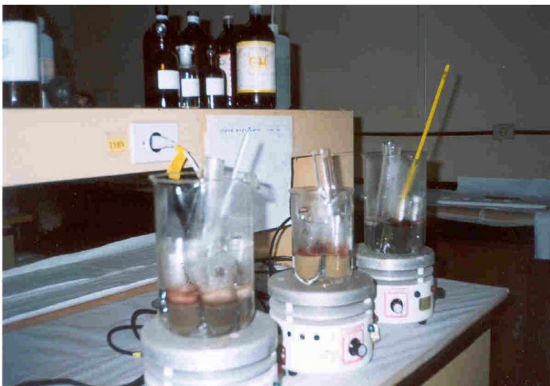
Foto 4.4 – Agitadores com Beker contendo os tubos de ensaio com a solução da fase redutível.
