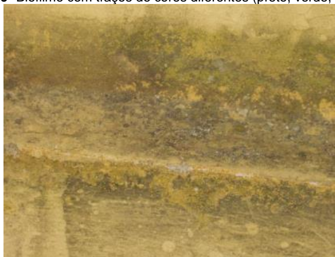
Figura 9- Biofilme com traços de cores diferentes (preto, verde, amarelo)
