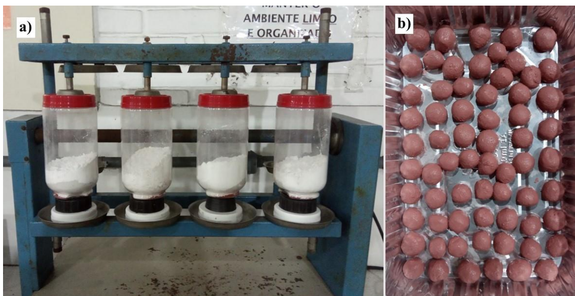
Figura 3. Equipamento para homogeneização das farinhas (a) e pelotas produzidas para clinquerização (b).
