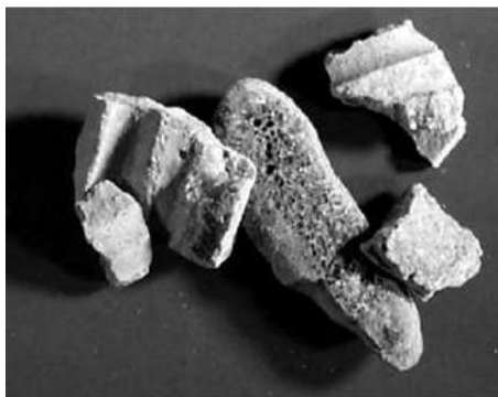
Figura 2.5: Amostra de incrustação de carbonato de cálcio retirada de uma tubulação. Fonte: (KALFAYAN, 2008)
