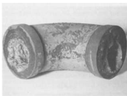
Figura 2.9: Incrustação de carbonato de cálcio em uma curva com 3" de diâmetro.
