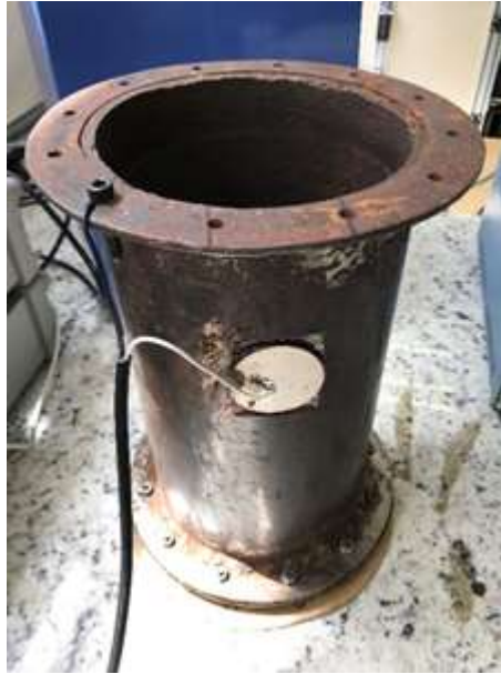
Figura 3.2: Trecho de tubo de aço carbono com a cerâmica piezoelétrica acoplada.
