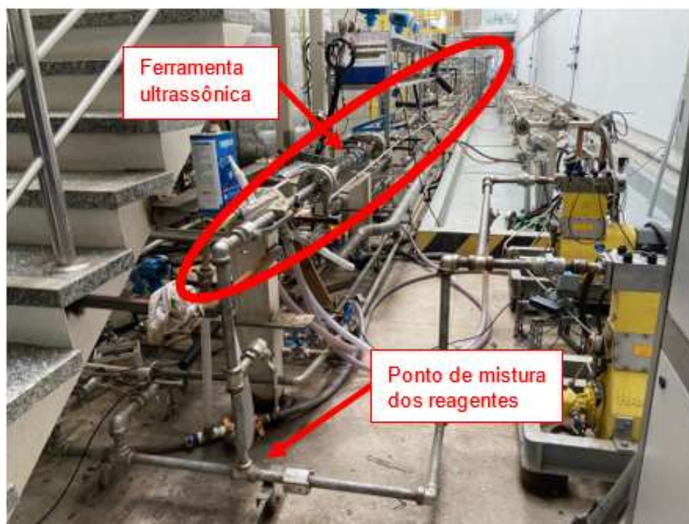
Figura 4.8: Linha de alta pressão do NIDF, com destaques para a ferramenta ultrassônica e o ponto de mistura dos reagentes.
