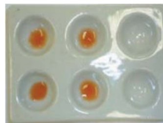
Figura 2. Placa de toque utilizada para identificação de peroxidase nas frações obtidas da coluna cromatográfica
