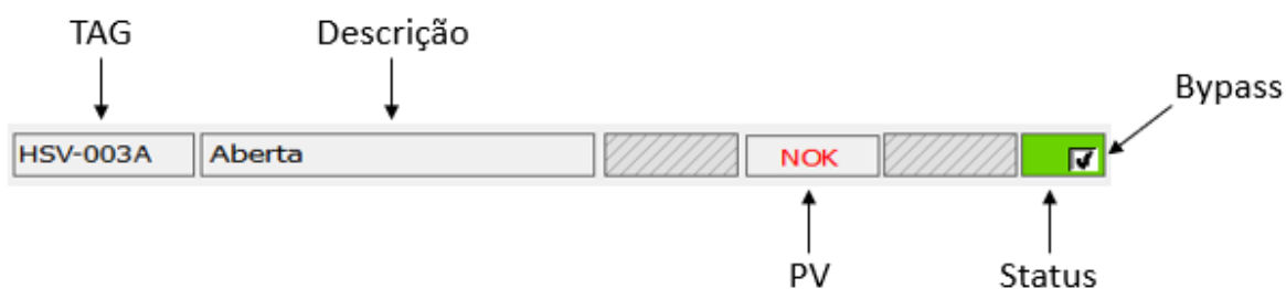
Figura 19 – Template da Tela de Operação - Variável Digital com Bypass ativado
