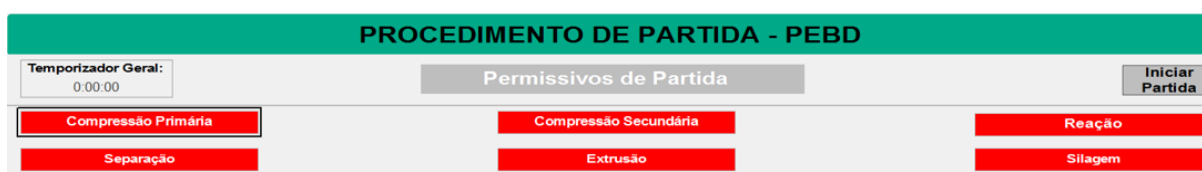
Figura 30 – Layout do Menu Superior do Procedimento de Partida do PEBD antes de iniciar
